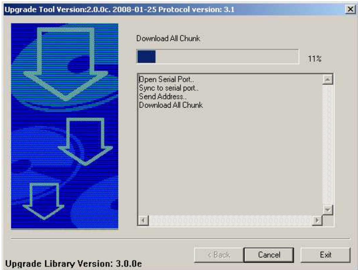
11. Program rozpocznie zapis danych do pamięci nieulotnej odbiornika. **POD ŻADNYM POZOREM NIE WOLNO WYŁĄCZAĆ ODBIORNIKA Z ZASILANIA W TRAKCIE TEJ CZYNNOŚCI, SPOWODUJE TO USZKODZENIE DANYCH I UNIEMOŻLIWI URUCHOMIENIE ODBIORNIKA**
